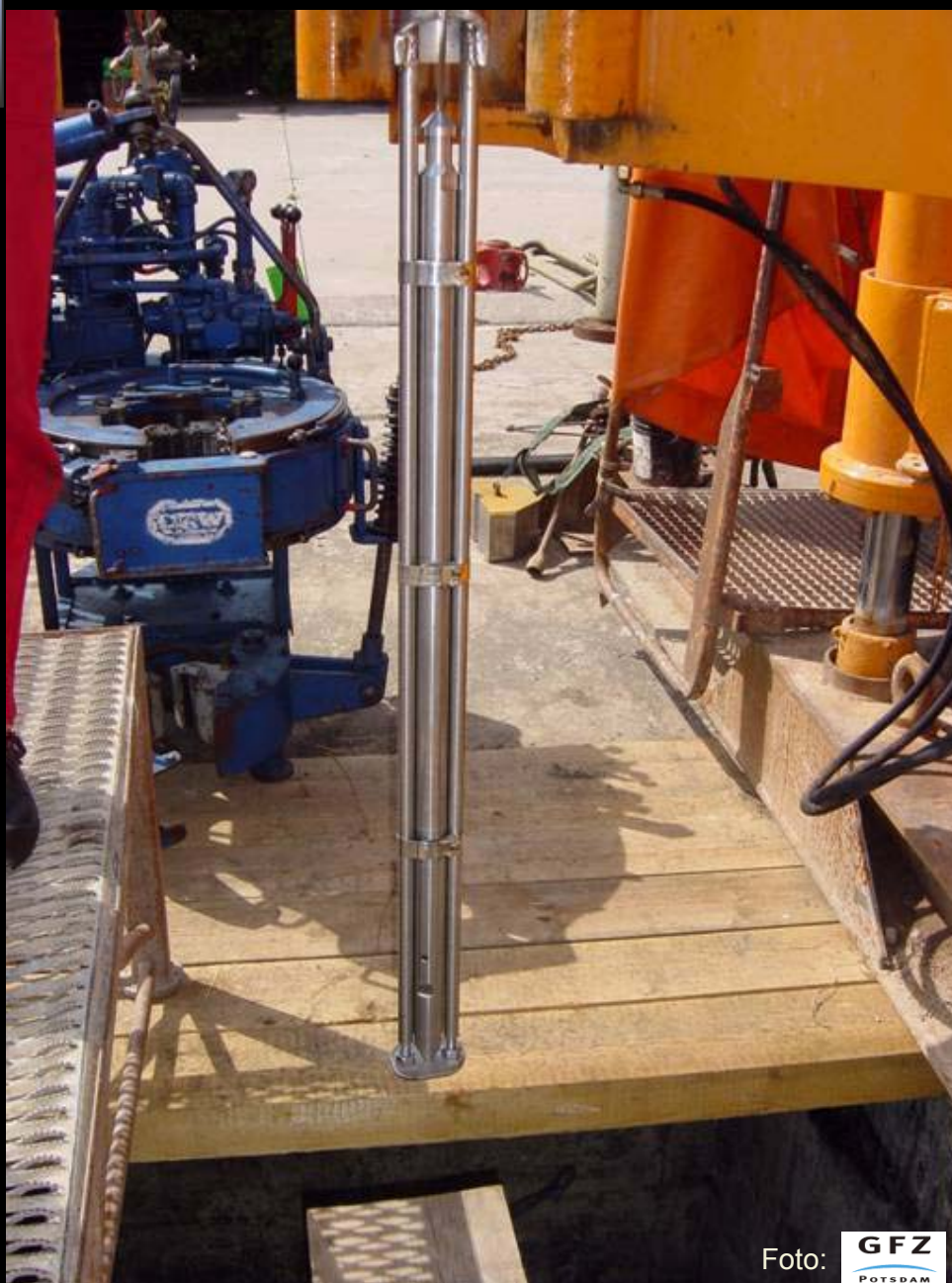
Druck- sonde unter der Pumpe
